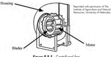
Figure 9.8.5. Centrifugal fan
