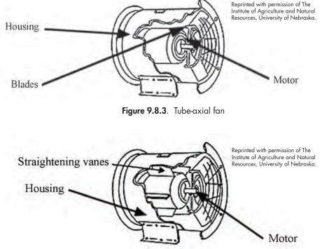
Figure 9.8.4. Vane axial fan
