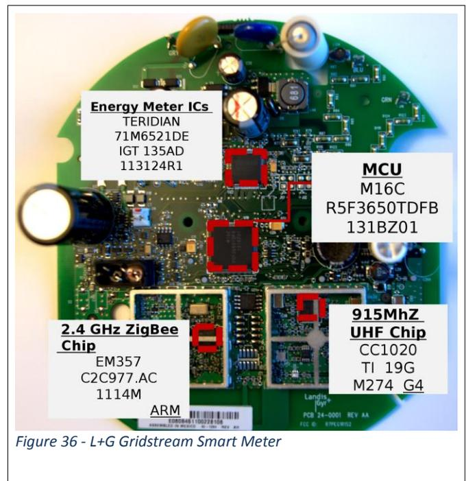
Figure 36 - L+G Gridstream Smart Meter
