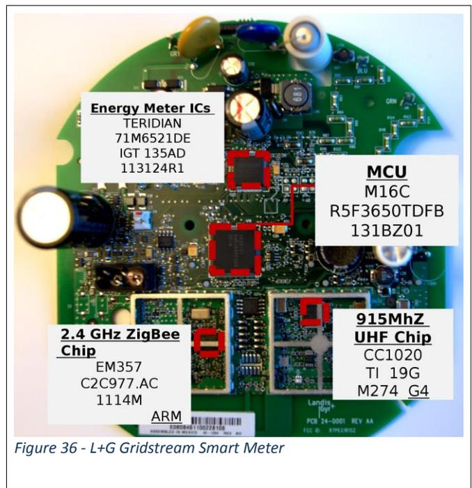
Figure 36 - L+G Gridstream Smart Meter
