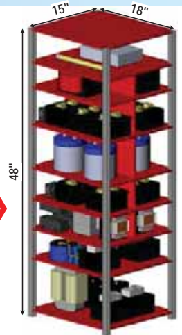
Gen- 3 SST: 40 kHz 15 kV SiC
