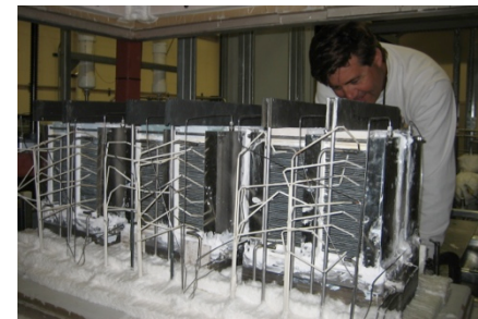
720 cell 12-stack module
