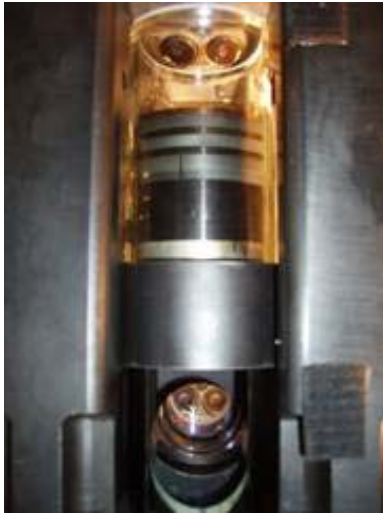
MIT rapid compression machine (fuel/stratification)
