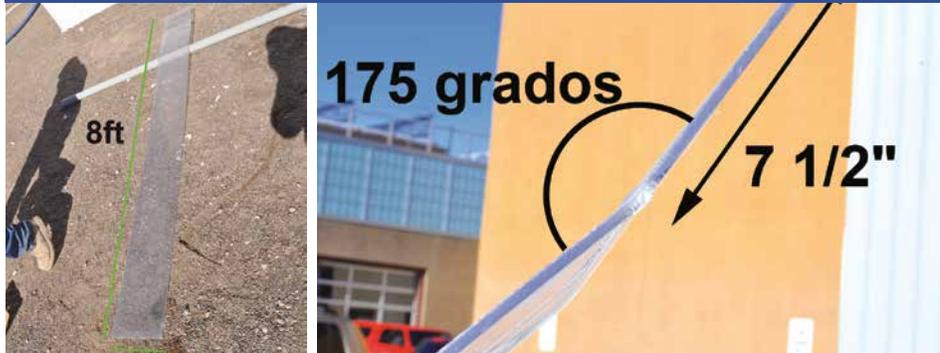
De ser necesario, prepare una herramienta plástica y flexible de relleno de aislamiento para guiar el aislamiento hacia la cavidad.
