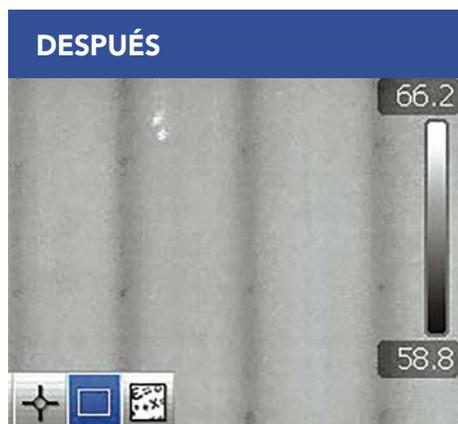
Cuando se aísla correctamente, el rendimiento térmico de la pared mejora y disminuyen las fugas de aire. (Las cavidades de las paredes que se muestran con un sombreado más claro en esta imagen térmica están aisladas).
