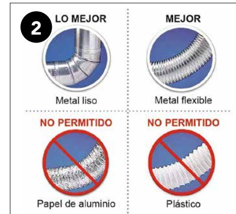
El material del conducto debe ser de metal rígido o semirrígido.
