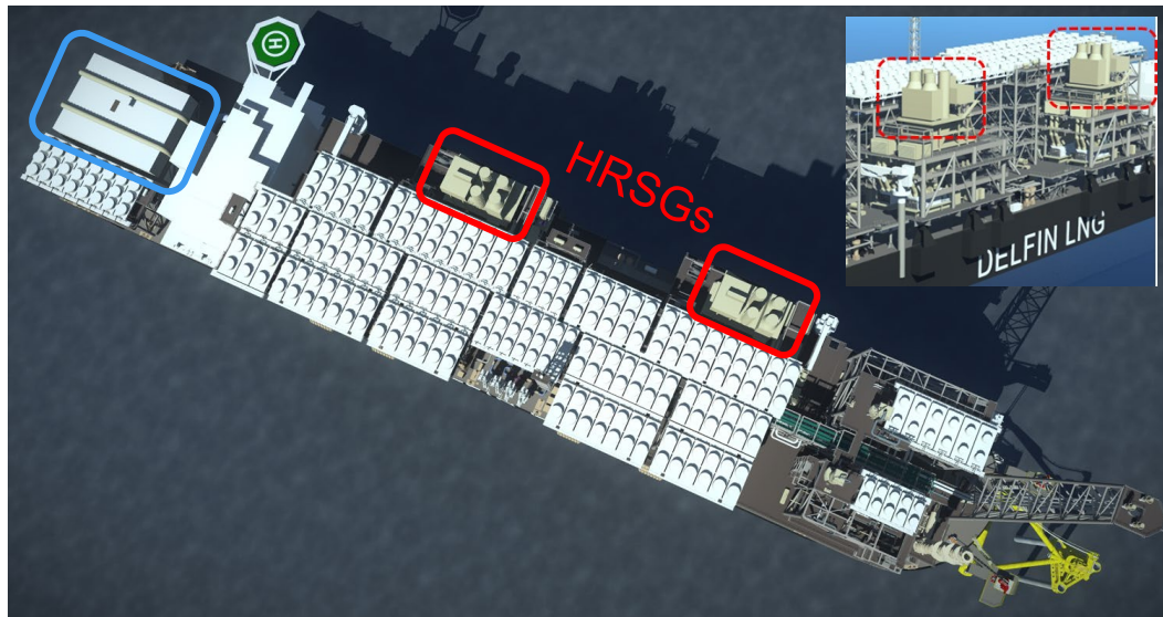
Figure 5 ACC and HRSG Location on the FLNGV
