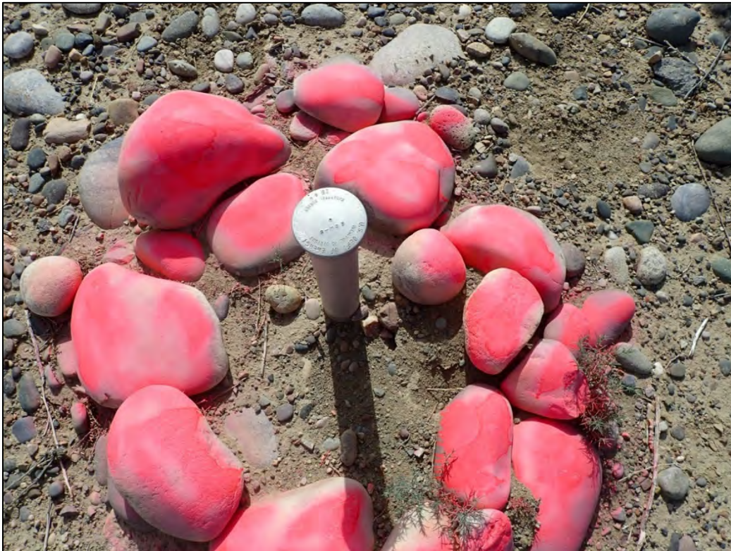
PL-6. Erosion Control Marker ECM-5
