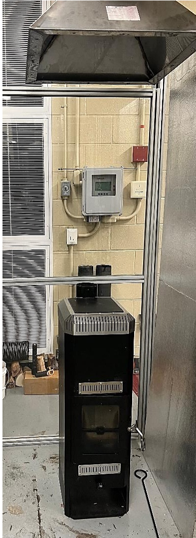
Baseline wood heater (Katykid) operated at UA
