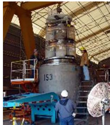
Tras la caracterización, los contenedores de CCO son cargados en TRUSPACT-II para transportación
