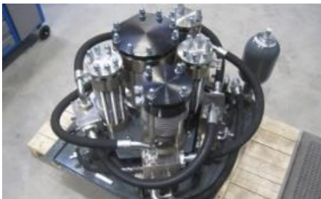
IC – Ionic Compressor (GH2)
