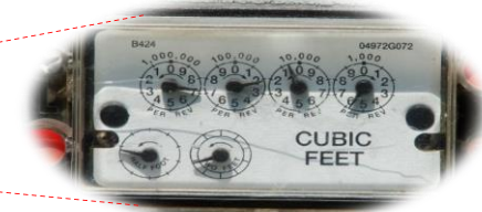
7 , 2 0 5 MCF (b) Analog Meter Readout
