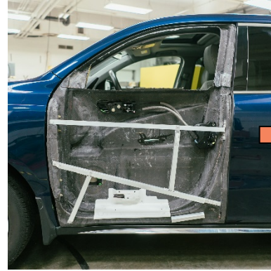
3. Test fit CFRP door frame in Acura MDX
