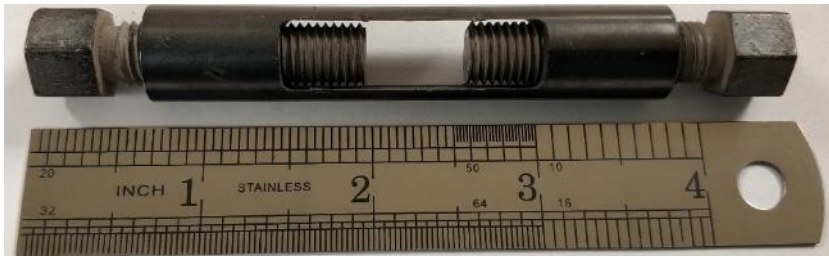
Diffusion couple jig (Kovar alloy)
