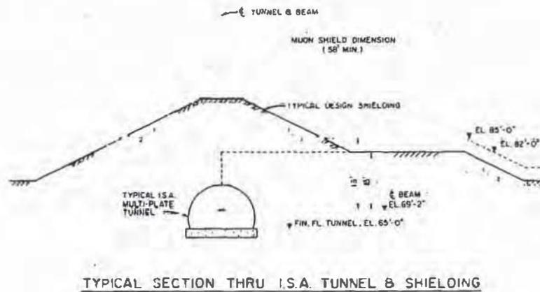
FIGURE 4.2.1.3.A MUON SHIELD DESIGN
