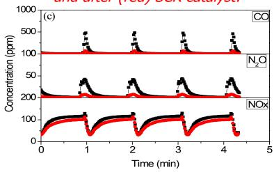
60 s L - 5 s R; L: 300 ppm NO, 8%  $O_2$ , 5%  $H_2O$ , 5%  $CO_2$ , bal.  $N_2$ ; R: 1%  $H_2$ , 5%  $H_2O$ , 5%  $CO_2$ , bal.  $N_2$ . GHSV = 30,000  $h^{-1}$
