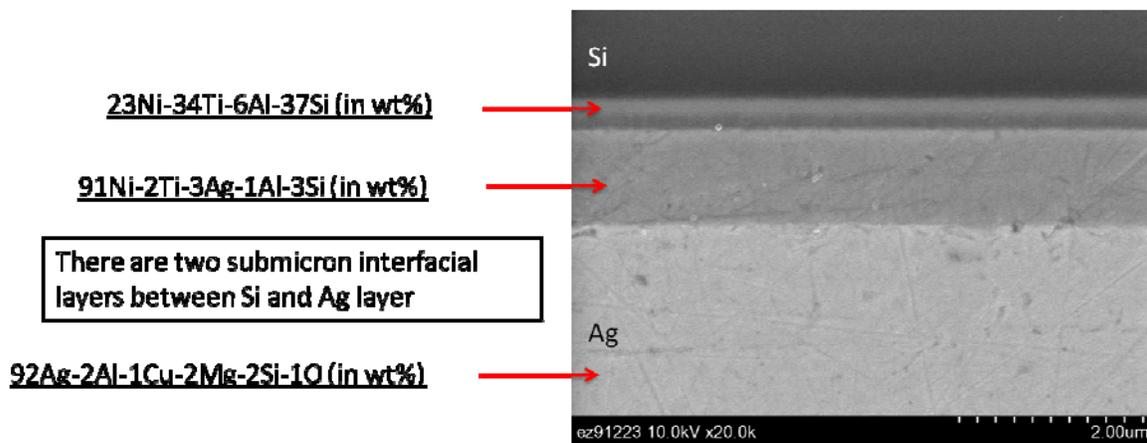
Fig. 5. Semikron SKiM die attach metallurgical scheme.
