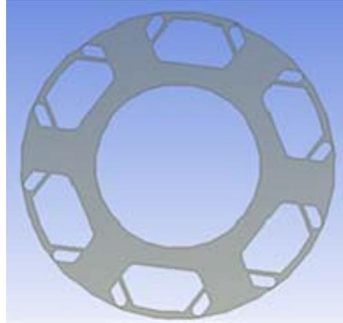
**Fig. 4. Rotor punching.**
