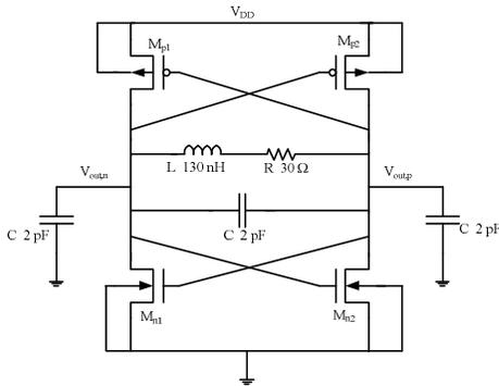
Fig. 23. LC-tank oscillator.
