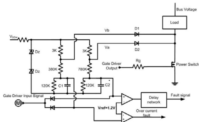
Fig. 26. Desaturation SCP.
