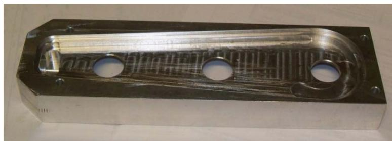
**Fig. 14. Inverter flow header.**
