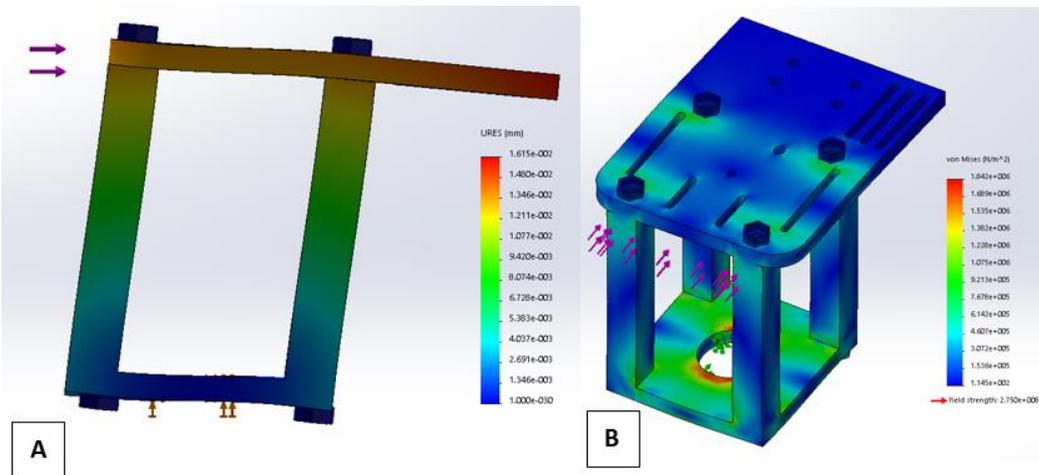
Figure 8: SolidWorks FEA: Nacelle displacement (A) and von Mises Stress (B).
