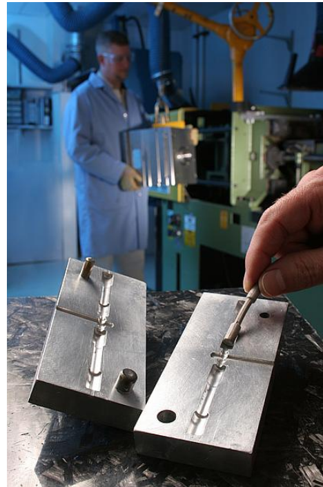
太平洋西北国家实验室的研究人员开发了新型粘结剂用于钛粉喷射塑型。
