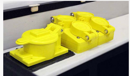
On board 120 & 240 Volt Outlets
